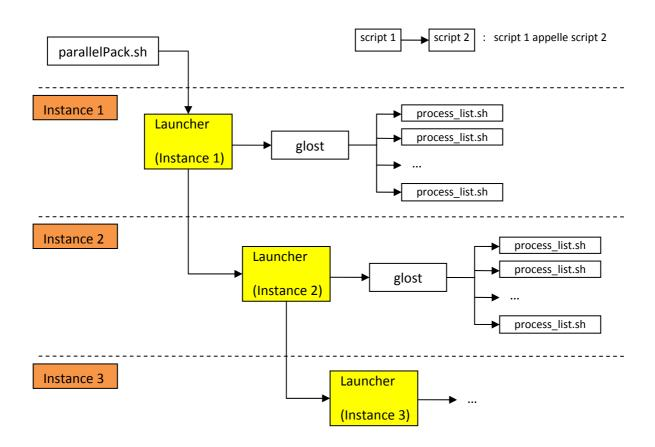
Figure 1 : schéma des appels des scripts de traitements des données d'un utilisateur
